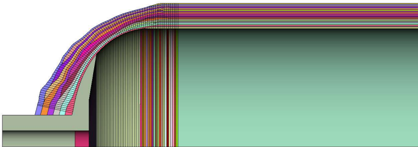
LS Dyna Model: Detailmodell des Wasserstoffdrucktanks
